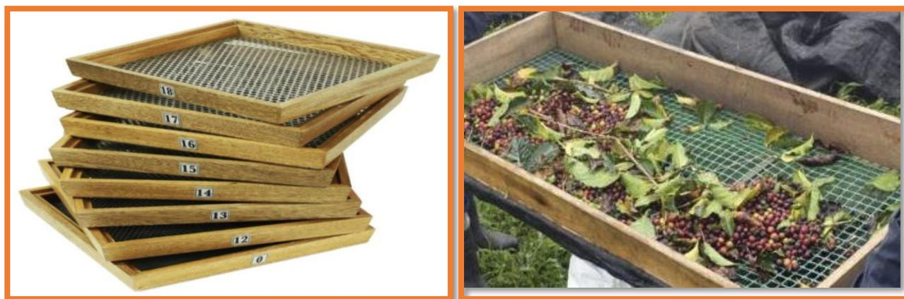
Figura 2. Mallas de zarandeo granulométrico de café. Fuente: Sanz-Urbe et al. (2022).
